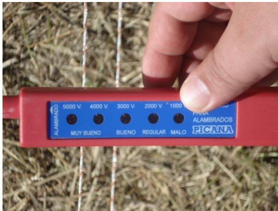
Imagen 34: Voltímetro para medir intensidad de la patada.
