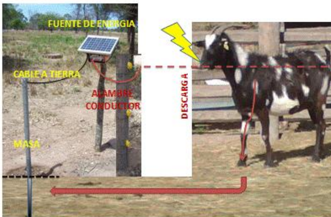
Figura 10: Esquema del funcionamiento del alambrado eléctrico.
